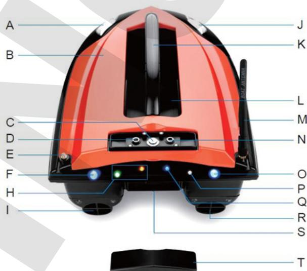
**A/J: Индикатор фронтальных ламп:** Функция освещения и местоположения позволяет повысить видимость, когда кораблик находится на удалении. Когда кораблик движется вперед, горят два фронтальных светодиода белого цвета.
